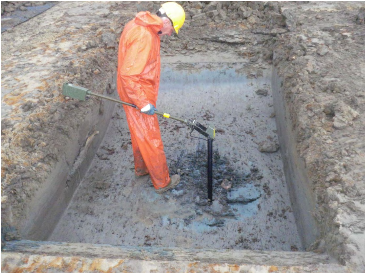
Figuur 2 Benadering van een mogelijke NGE. De locatie van de inslag is goed in het vlak te zien.
